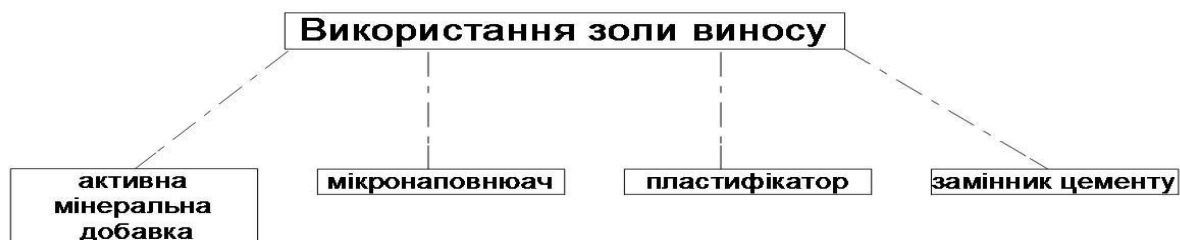
Схема 1- Використання золи виносу у виробництві будівельних матеріалів
